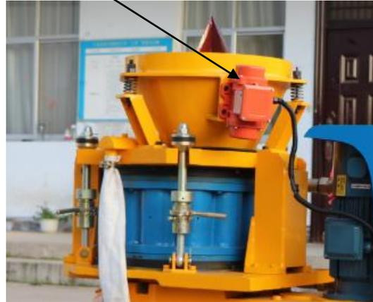
◆ Protect Frame/电器元件保护架
